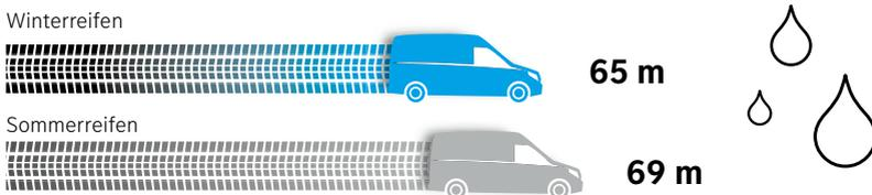
ABS-Bremsverzögerung von 100 auf 0 km/h bei 5°C Aussentemperatur auf nasser Straße.
